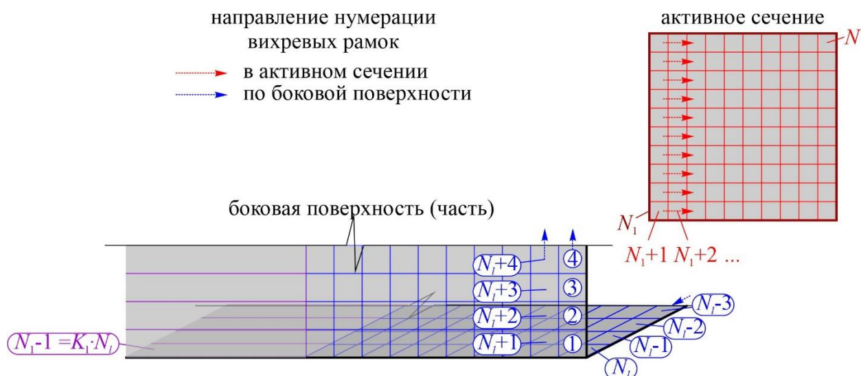
Рисунок 1.17 – Дискретная математическая модель, нумерация присоединенных вихревых элементов — квадратных вихревых рамок и прямых подковообразных вихрей
